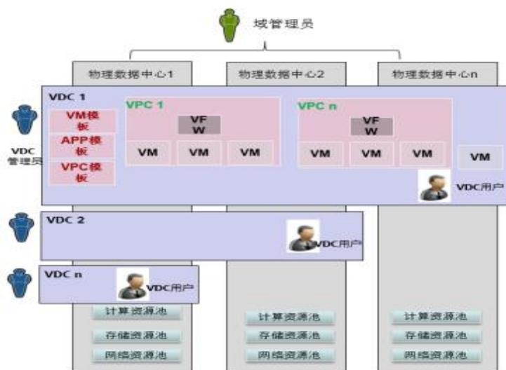
将校园云平台之中的物理资源进行“池化”，可以根据各个部门不同的诉求灵活划分和分配物理资源，同时提供对应的服务，并让各个部门独立管理以及使用本 VDC 的资源，将整个校园云平台的超级管理员的工作进行分摊以及管理上分权，降低超级管理员的管理成本,更灵活的满足不同部门、用户的要求。
